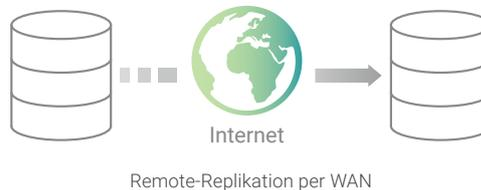
QReplca 2.0 nutzt die iSCSI-Funktion, um eine Replikationsverbindung herzustellen. Für optimale Backup-Geschwindigkeit kann die volle Bandbreite des zugeordneten Netzwerkports genutzt werden. Um den Replikations-Datenverkehr und den restlichen Netzwerkverkehr auszugleichen, kann die Traffic-Shaping-Funktion genutzt werden um ausreichend Bandbreite für den restlichen I/O-Transfer bereit zu halten.
