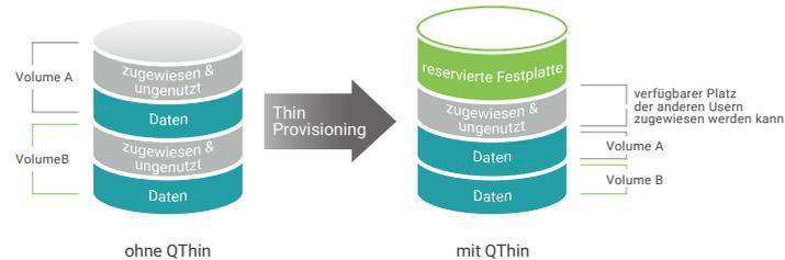
QThin nutzt unsere fortschrittliche Speicherpool-Architektur um diese Funktionalität umzusetzen. Die Kapazität des Speicherpools wird von allen Volumes innerhalb des Pools genutzt. Damit können die Systeme der XS3200-Serie mehr Hostserver mit einer kleineren Anzahl Festplatten bedienen und verringern somit die Anschaffungskosten. Es können bei steigendem Bedarf jederzeit weitere Laufwerke während dem Betrieb ohne Ausfallzeiten hinzugefügt werden.
